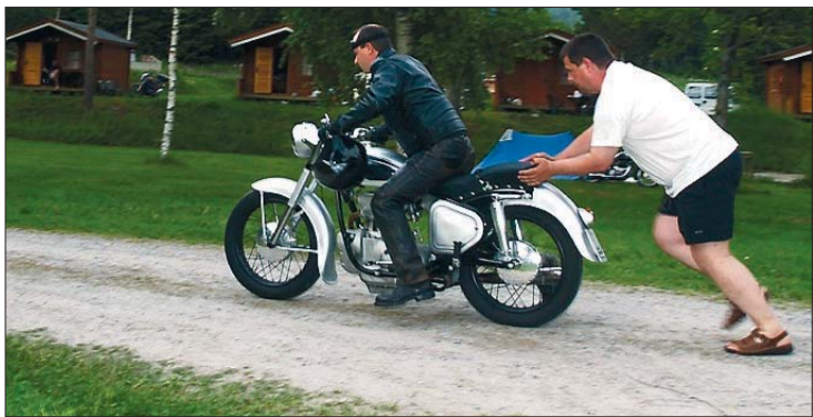
Med lunefull magnettenning på en AVO 350 1961 modell fra DDR, hender det at det trengs en liten dytt når motoren er lunken, Atle Morsund i NVMCS fikk jobben som dytter.
